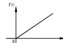
Corresponde a um sinal de “varredura”, isto é, um sinal mecânico ou elétrico que indica uma mudança (aumento) linear de valor com o tempo.
