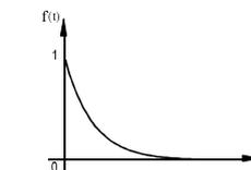
Temos um sinal que decai exponencialmente, com constante de tempo  $\tau = 1/\alpha$ . É o que ocorre, por exemplo, quando um copo de água quente esfria em contato com o ambiente, ou durante a descarga de um capacitor em um circuito passivo, ou ainda durante o retorno de um amortecedor mecânico elástico.
