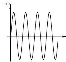
Descreve uma oscilação harmônica com frequência angular  $\omega$ . A frequência em ciclos por segundo é  $f$  ( $\omega = 2\pi f$ ). Por exemplo, poderia ser uma massa oscilando presa a uma mola, sem atrito, ou a corrente elétrica por um circuito LC ideal.
