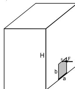
**Exercício 17)**<sup>4</sup> Determinar a altura da lâmina d'água (H) para que a comporta automática se abra, sabendo-se que a altura da articulação em relação ao solo é de 30 cm.
