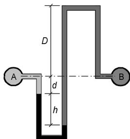
**Exercício 13)**<sup>5</sup> Na figura, o manômetro de mercúrio indica uma leitura diferencial  $h = 12 \text{ cm}$  quando a pressão no tubo B é de  $500 \text{ mmHg}$ . O tubo A contém água e o tubo B contém óleo (densidade relativa = 0,92). Se  $d = 6 \text{ cm}$  e  $D = 20 \text{ cm}$ , qual a pressão no tubo A? Resp.:  $388 \text{ mmHg}$
