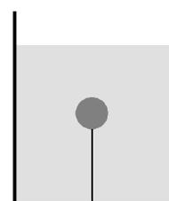
**Reforço:** Qual seria a tensão no fio se a esfera de isopor tivesse um raio externo de 8cm mas fosse oca, com espessura de 5mm? *Resp.: 19,7N*
