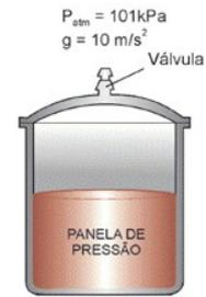
Considere os dados fornecidos na figura e na tabela acima, e uma situação em que a panela contém água saturada. Suponha que a válvula tenha massa de 80 gramas e diâmetro de contato efetivo com o vapor de 1,6mm. Qual será a temperatura da água e a pressão manométrica do vapor no interior da panela?
