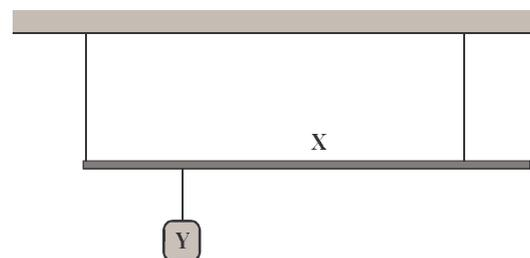
**Reforço:** Qual seria a tensão na corda presa na extremidade esquerda se o bloco estivesse pendurado na extremidade direita da barra? *Resp.: 16N*
