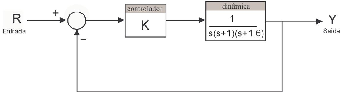
2. Para  $K=2$  e para  $K=3$ , encontre, a partir da resposta em frequência, o modelo simplificado de 2º grau do sistema (especificando os valores de  $\xi$  e  $\omega_n$ ).
